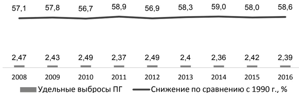
Рисунок. Прямые удельные выбросы парниковых газов электролизных производств, т, в эквиваленте CO<sub>2</sub> на 1 т алюминия
