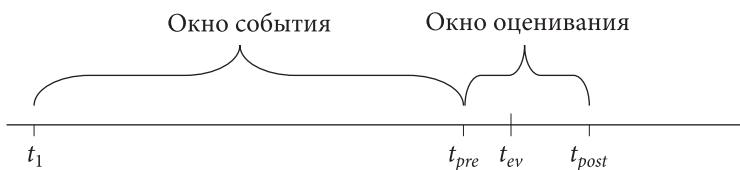
Рис. 5. Окно оценивания и окно события на оси времени
