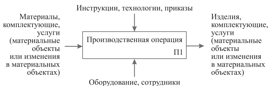
Рис. 2. Использование IDEF0 для описания производственных процессов
