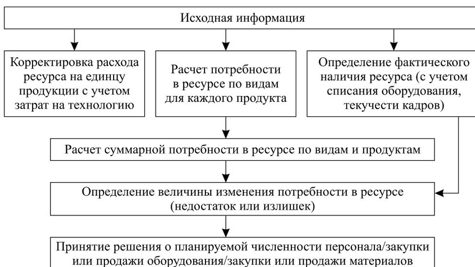
Рис. 4. Блок-схема алгоритма планирования производственных ресурсов
