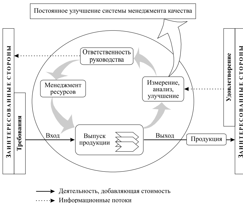
Рис. 1. Модель системы менеджмента качества, построенная на основе процессного подхода (ИСО 9001:2000)
